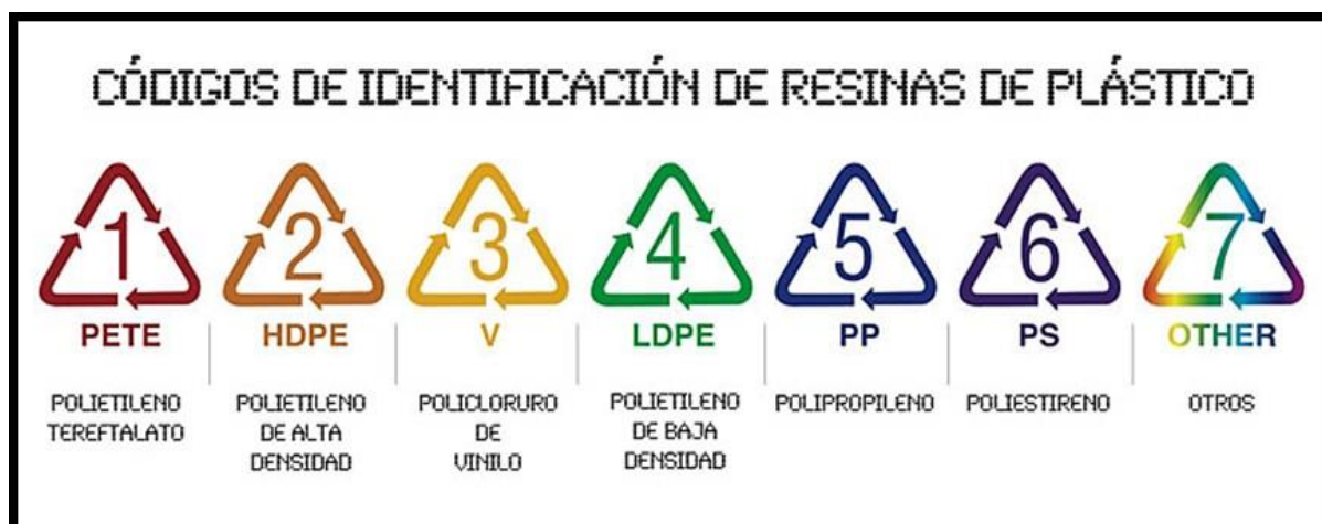
Figura 3. Códigos de identificación de resinas de plástico. Fuente: National Geographic, Gestores de Residuos, Recytrans.
