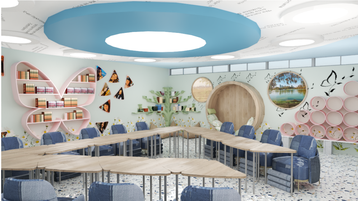
Figura 21. Vista 2 de espacio terminado, con la propuesta de lockers circulares hechos de tubos de desagüe de 10" pintados en rosado.
