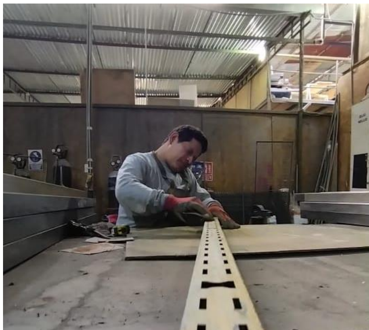
Figura 17. Fotografía referencial del proceso de lijado de piezas metálicas.
