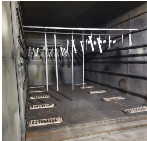
Figura 18. Fotografía referencial del proceso de pintado al horno de las piezas metálicas.
