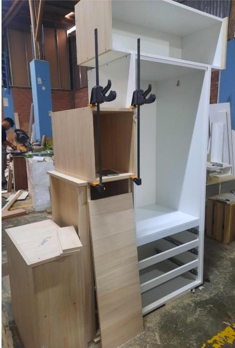
*Figura 11: Proceso de armado por módulos /
