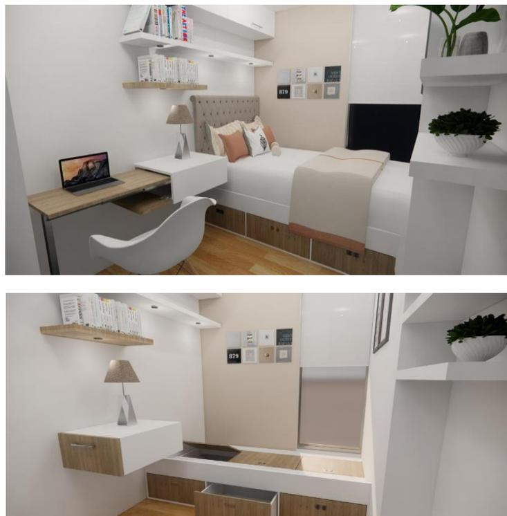
*Figura 15. Vista 3D de cama de 1.5plz con cajoneras inferiores e internas. Elaboración propia*
